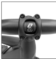
Dopo: manubrio installato
